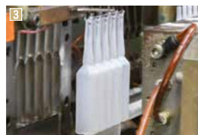
1 容器の先端を切って土に挿すことで、植物の生育に必要な栄養が一定のペースで土に浸透する 2 観葉植物やバラなど、植物に合わせた活力剤を展開 3 0.1ミリ単位で厚さを調整し、製造された自社製の容器
