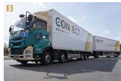
1 材料の加工から溶接、組み立て、塗装など全ての工程を工場内で行う 2 開発される車両は回転半径や強度などのデータ検証が繰り返される 3 効率化を図るために開発されたダブル連結トラック
