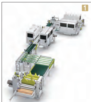
1 工場のラインに導入されるダブルエンドテノーナ 2 独自のチェーンとレールで建材を搬送させ、切削加工を行う 3 機械の組み立ては熟練した技術をもつ職人の手で行われる
