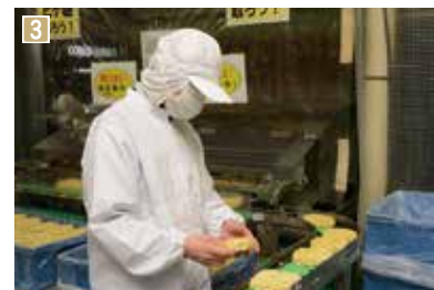
1 原料の配合からパッケージまで、自動で製造を行う 2 発売以降、麺やスープの味を変えず、懐かしの味を提供し続けている 3 検品の作業はセンサーに加え、一つ一つ丁寧に人の目で行う
