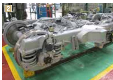
1 安全性や快適性・利便性などの向上を目指し造られたN700S新幹線 2 車両の走行やブレーキ、揺れの抑制などの役割を担う新幹線の台車 3 既存の技術を改良するため、さまざまな資料を持ち寄り議論を重ねる
