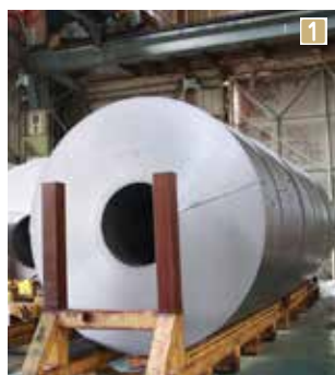
1 材料となる板状の鋼材(コイル)からスチールホイールを製造する 2 豊川製造所で造られるスチールホイール 3 出荷前は機械だけでなく人の目でも検査を実施
