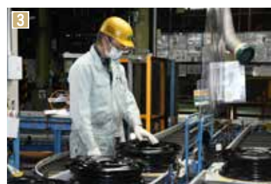
1 材料となる板状の鋼材(コイル)からスチールホイールを製造する 2 豊川製造所で造られるスチールホイール 3 出荷前は機械だけでなく人の目でも検査を実施
