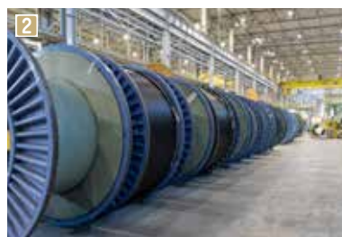
1 銅線を取り巻くように絶縁体などが幾層にも巻かれている 2 完成した電力ケーブルは、大きいもので直径5mにもなるドラムに巻いて保管している 3 異物検査ではケーブルの断面を顕微鏡で確認している
