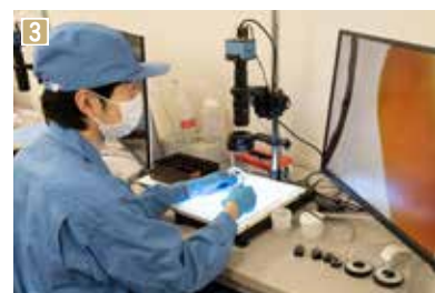
1 銅線を取り巻くように絶縁体などが幾層にも巻かれている 2 完成した電力ケーブルは、大きいもので直径5mにもなるドラムに巻いて保管している 3 異物検査ではケーブルの断面を顕微鏡で確認している
