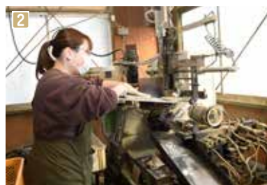
1 真ちゅうで作られた「しっぽシリーズ」の一つであるマスク掛け「しっぽ貸し手」2 専用の機械で絶縁筒を切削加工していく 3 定期的に社内ミーティングを行い、活発なコミュニケーションを大切にしている
