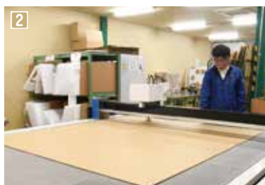
1 落下試験機で安全性や強度を測定する 2 図面データから包装資材の試作品を作成するサンプルカッター 3 梱包する製品に合わせて、さまざまな素材や形状で作られた包装資材
