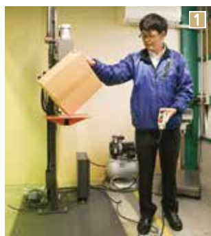
1 落下試験機で安全性や強度を測定する 2 図面データから包装資材の試作品を作成するサンプルカッター 3 梱包する製品に合わせて、さまざまな素材や形状で作られた包装資材
