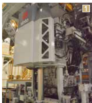
1 砂を固めて型を作る機械「造型機」2 ポストやフライパンなど、鑄造設備から作られるさまざまな製品 3 IT技術の導入など、複雑化する顧客のニーズに合わせて計画・設計を行う
