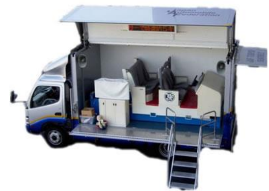
模擬体験車両 シートベルトコンビンサー (模擬衝突体験機)
