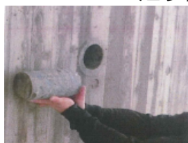
コア抜き調査
