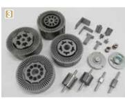
1 人の目で不具合などがないか一つ一つ検査を行う2 小型化したプレ ス機を組み合わせて加工速度と生産性を上げる独自ライン。プレス加工によって製造された、自動車のモーターなどに使われる部品
