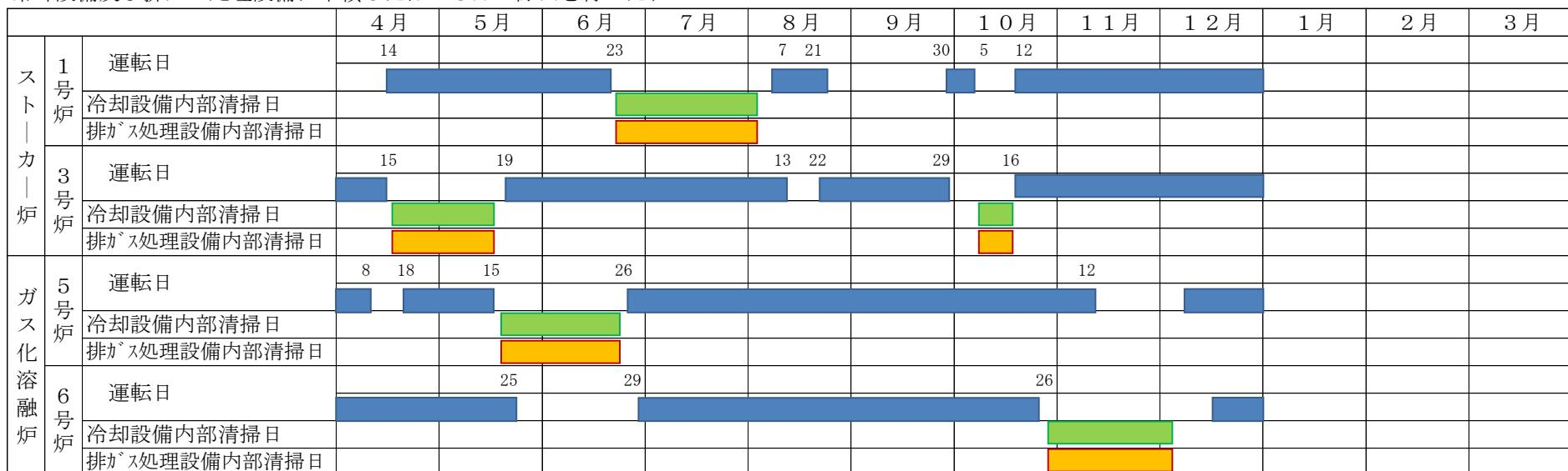
冷却設備にたい積したばいじんの除去： 5・6号炉は、運転日は1日2回ストートプロワを実施、定期点検時には内部清掃を実施。
