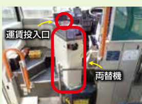
運賃投入口と両替機
