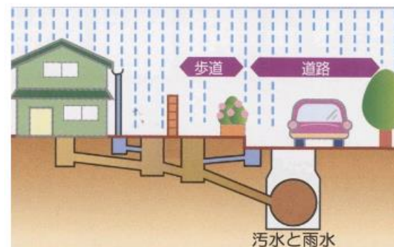
下水の排除方式（合流式）
