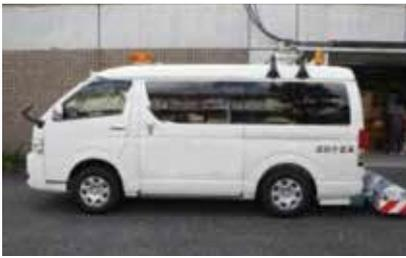
路面下空洞探査車
