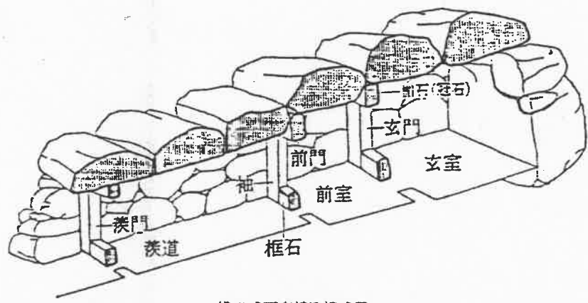
横穴式石室構造模式図
