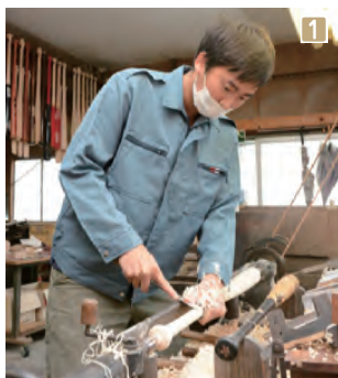
1 10種類以上の道具を使い分け切削する 2 材料となるメイプルやホワイトアッシュなど、約10種類の木材を常時5万本以上保管している 3 海外向けに販売しているオリジナルブランド「SPARK」のバット
