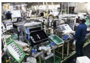
1シフトレバーの種類ごとに専用の検査機で動作確認を行っている2作業効率を意識し、柔軟に動線を変更できるように、移動可能なライン3約40種類のシフトレバーを製造し、国内外の車種に搭載されている
