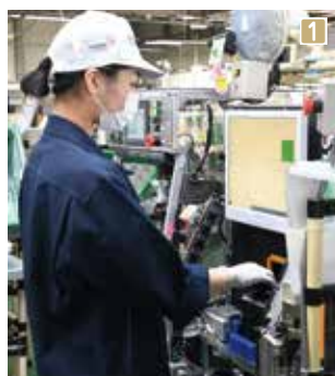
1シフトレバーの種類ごとに専用の検査機で動作確認を行っている2作業効率を意識し、柔軟に動線を変更できるように、移動可能なライン3約40種類のシフトレバーを製造し、国内外の車種に搭載されている
