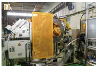
①人の目で不具合がないか一つ一つ検査を行う②小型化したプレス機を組み合わせると加工速度と生産性を上げる独自ライン③プレス加工によって製造された、自動車のモーターなどに使われる部品
