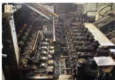
1 生産過程の課題などについて、金型製造部門と生産部門で話し合いを重ねる 2 常温の下、世界最大級といわれる1300トンの力を加えて鉄材を成形する設備 3 円柱形の鉄材(左)が独自製法により成形される(右)
