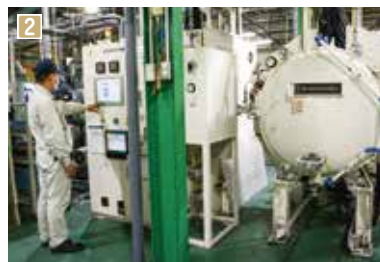
1 金属の粒を押し固めて作られたフィルター。用途によりさまざまな形状がある 2 真空状態の中で、原料となる金属の粒に熱を加える装置 3 3D(立体画像)で計測できる機器を活用した検査も行っている
