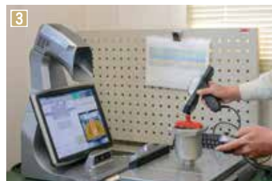
1 金属の粒を押し固めて作られたフィルター。用途によりさまざまな形状がある 2 真空状態の中で、原料となる金属の粒に熱を加える装置 3 3D(立体画像)で計測できる機器を活用した検査も行っている
