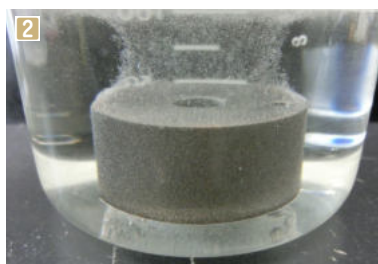
1 薬品に入れる成分は微量で性能が変わる 2 さび取り剤にさびた金属を入れてテストを行っている様子 3 工場ではさび取り剤をはじめ、多種多様な化学製品の開発・製造を行っている
