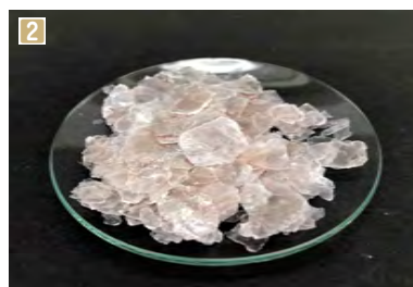
1 マイカパウダーの粒子分布などを画面で確認し、品質検査を行う 2 粉砕処理を行う前の、原料となる雲母 3 マイカパウダーにはさまざまな大きさや表面加工されたものがあり、化粧品用パウダーなどの材料となる
