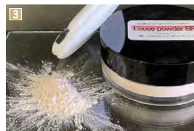
1 マイカパウダーの粒子分布などを画面で確認し、品質検査を行う 2 粉砕処理を行う前の、原料となる雲母 3 マイカパウダーにはさまざまな大きさや表面加工されたものがあり、化粧品用パウダーなどの材料となる
