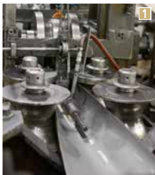
1 板状の鉄を、両側に配置された金型に通して力を加え徐々に丸めていく 2 直径165.2、厚さ1.2mmの大径薄肉鉄パイプ 3 納品先業者による鉄パイプの加工例。柔らかさを残しているため自在に加工が可能
