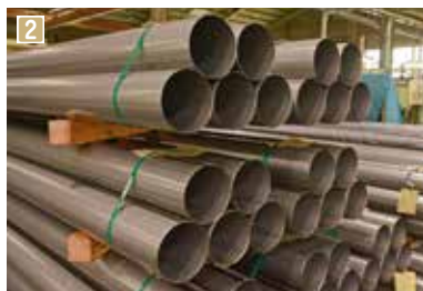
1 板状の鉄を、両側に配置された金型に通して力を加え徐々に丸めていく 2 直径165.2、厚さ1.2mmの大径薄肉鉄パイプ 3 納品先業者による鉄パイプの加工例。柔らかさを残しているため自在に加工が可能
