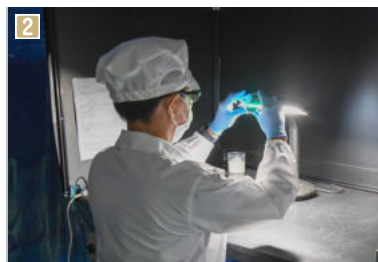
1 レンズに薄い膜を重ねる機械の操作はモニターを見ながら行う 2 薄い膜のコーティングを何十層にも重ねたレンズの検品 3 光を自在にコントロールして色を操る伊藤光学工業の製品
