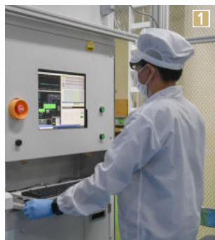
1 レンズに薄い膜を重ねる機械の操作はモニターを見ながら行う 2 薄い膜のコーティングを何十層にも重ねたレンズの検品 3 光を自在にコントロールして色を操る伊藤光学工業の製品
