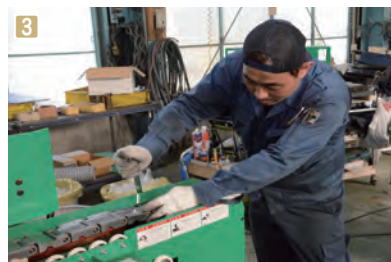
1 工場のラインに導入されるダブルエンドテノーナ 2 独自のチェーンとレールで建材を搬送させ、切削加工を行う 3 機械の組み立ては熟練した技術をもつ職人の手で行われる
