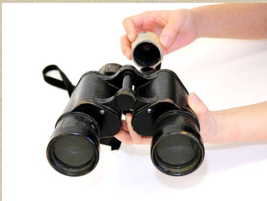
豊川海軍工廠で生産された双眼鏡 豊川海軍工廠の光学部という部署では、光学機器（双眼鏡や潜望鏡など）や、計測機器（測距儀や羅針儀など）を作っていました。これは手持ち用の7倍双眼鏡です。
