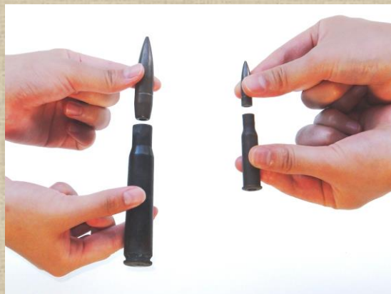
豊川海軍工廠で生産された弾莢 (弾丸と薬莢) 豊川海軍工廠（火工部）では、機銃が生産され、弾丸も大量に作られました。
